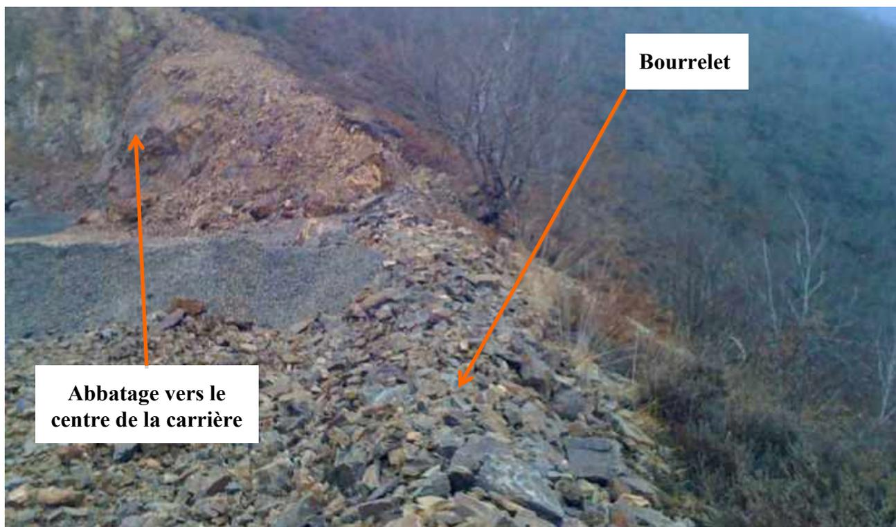
Pour limiter les risques de chute de blocs pendant l'extraction, la procédure générale préconisée et mise en œuvre par l'exploitant est la suivante :
